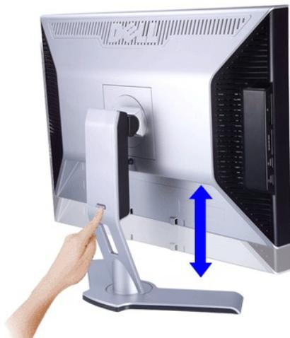
**NOTA:** Si está bloqueado, pulse el botón de bloqueo/desbloqueo situado en la parte trasera del soporte. Levante el panel frontal y extienda el soporte hasta la altura que desee.
